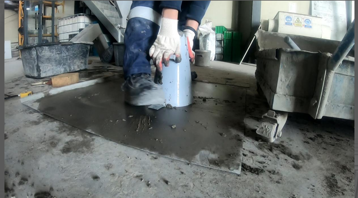
НАНО бетон – 230mm
