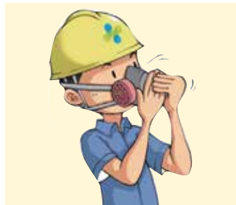
3 손바닥으로 배기밸브를 막은 후 부드럽게 숨을 내신다. 면체가 부풀어오르고 얼굴과 면체 사이로 공기가 새는 것이 느껴지지 않도록 양압 밀착검사를 실시
