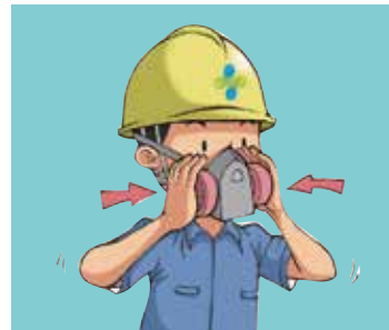
4 손바닥으로 정화통을 막은 후 숨을 들이쉰다. 면체가 얼굴 쪽으로 오그라들고 면체와 얼굴 사이로 공기가 새는 것이 느껴지지 않도록 음압 밀착검사를 실시
