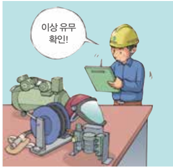
1 압축공기 공급원, 종압호스, 유량 조절 장치, 안면부 등의 이상 유무를 확인
