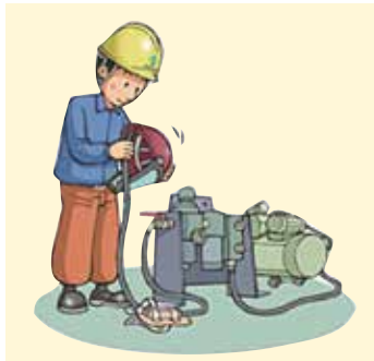
3 종압호스를 유압조절장치 및 여과장치에 연결하고 연결관을 안면부 및 유량조절장치에 연결
