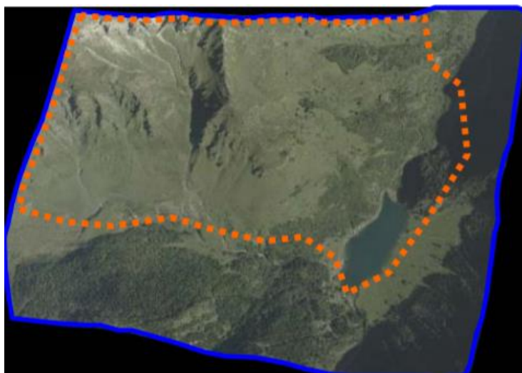
Е.19-р зураг- Нийлмэл ортозурагт хамаарах ортозургийн зурагласан талбай ба гажилтгүй зурагласан талбай ( нэрлэсэн дарааллаар цэнхэр, улбар шар) өнгөөр тэмдэглэсэн
