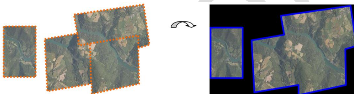
Е.20-р зураг-Нийлмэл ортозураг үүсгэх (зураглах талбайг цэнхэр өнгөөр), гажилтгүй ортозураг (гажилтгүй зураглах талбайг улбар шар өнгөөр)
