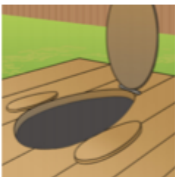
Битүүлсэн шаланд бие засах нүх гаргана. (том хүнд 50см урт 25см өргөн, хүүхдэд 28см урт, 18см өргөн) Бие засах нүх нь бүхээгийн арын хананаас 20см-ээс багагүй зайд байрлана. Бие засах нүхний хажууд 5см өндөртэй хөлийн гишгүүр байрлана.
