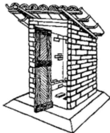
Хаяавчийн өндөр 5см, өргөн 10см байх бөгөөд цементэн зуурмагаар 15-20 градусын налуутай хийнэ.
