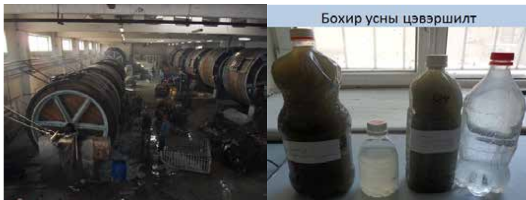
Зураг 34: Арьс ширний үйлдвэрийн бохир усыг биотехнологийн аргаар цэвэршүүлсэн байдал
