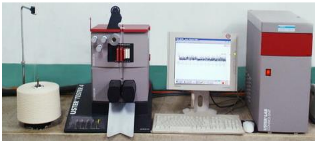
Зураг 57: USTER TESTER 4 багажны бүтэц бүрэлдэхүүний зураг
