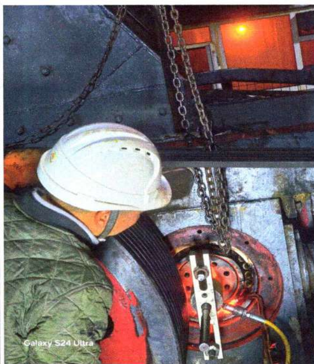
Хоёрдогч бутлуур Б холхивч дуутай байсныг шинээр 23140 ORW 33 С3 маркын холхивч шинээр солив.
