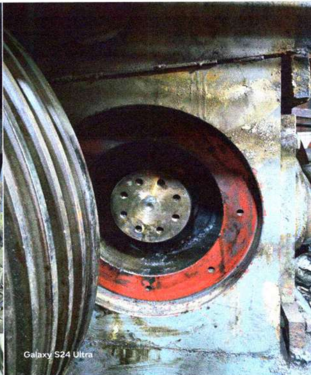
Хоёрдогч бутлуур Б холхивч дуутай байсныг шинээр 23140 ORW 33 С3 маркын холхивч шинээр солив.
