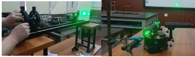
Зураг 6. Шувуу үргээх төхөөрөмжид ашиглах лазерын долгионы уртыг лабораторийн нөхцөлд тодорхойлж буй байдал
