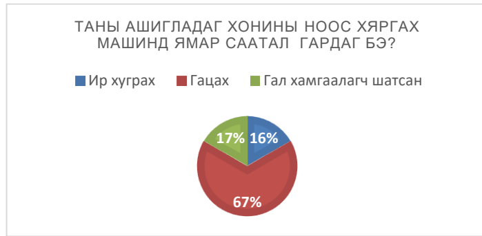
Зураг 5. Малчдын ашиглаж байгаа хонины ноос хяргах машины саатлын судалгааны үр дүн
