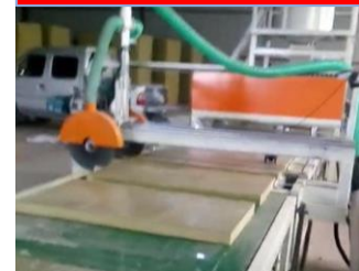
Файбер цементэн хавтан үйлдвэрлэх шугам
