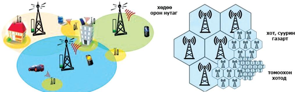
Бааз станцуудын үүсгэх үүрүүдийн тусlamжтайгаар үүрэн холбооны сүлжээний хамрах хүрээ тодорхойлогдох ба үүрүүд нь сүлжээнд ямар нэгэн "зай" үлдээхгүйгээр зохион байгуулагдах ёстой байдаг. "Цоорхойгүй" буюу шаардлагатай хамрах хүрээг үүсгэж байхаар тооцоолон бааз станцын байршил, антенны байрлалыг сонгодог. Хүн ам сийрэг газарт хол зайнд, хүн ам шигүү болох тусам бааз станцуудын зай ойртдог. Хот суурин газарт 200-300 метр тутамд бааз станц байрлуулдаг.
